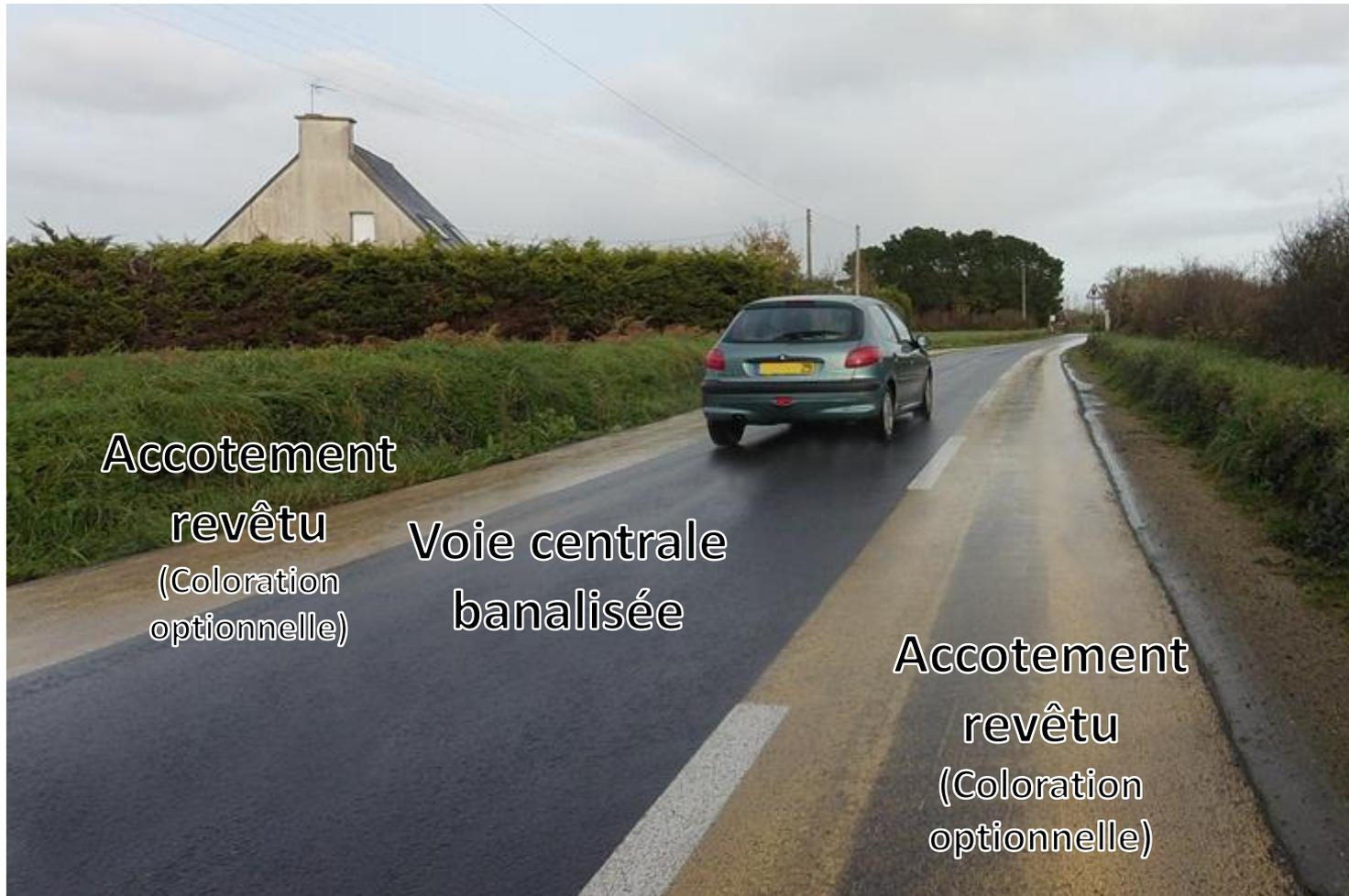
NB : Cette photo a été modifiée. Sur le terrain l'ancienne ligne axiale redevient visible, ceci amène à un mauvais positionnement (trop à droite) de certains véhicules.
