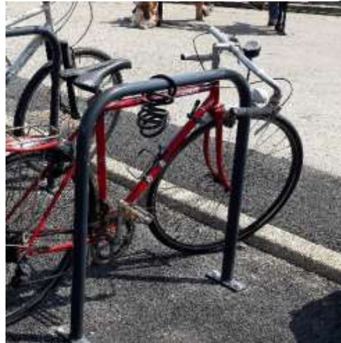
Figure 40 : Des arceaux de type "U renversé" sont une solution simple et qualitative permettant à la fois d'accrocher le cadre et au moins une roue
