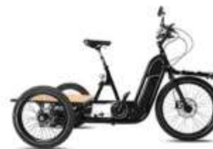
Vélo-cargo à assistance électrique tri-porteur, dédié au transport de gros volumes (12 bacs euro)
